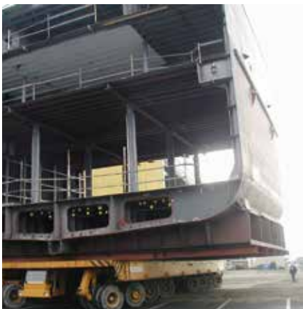
Die beiden vorgefertigten, insgesamt 28 Meter langen Schiffsrumpfmittelstücke.
