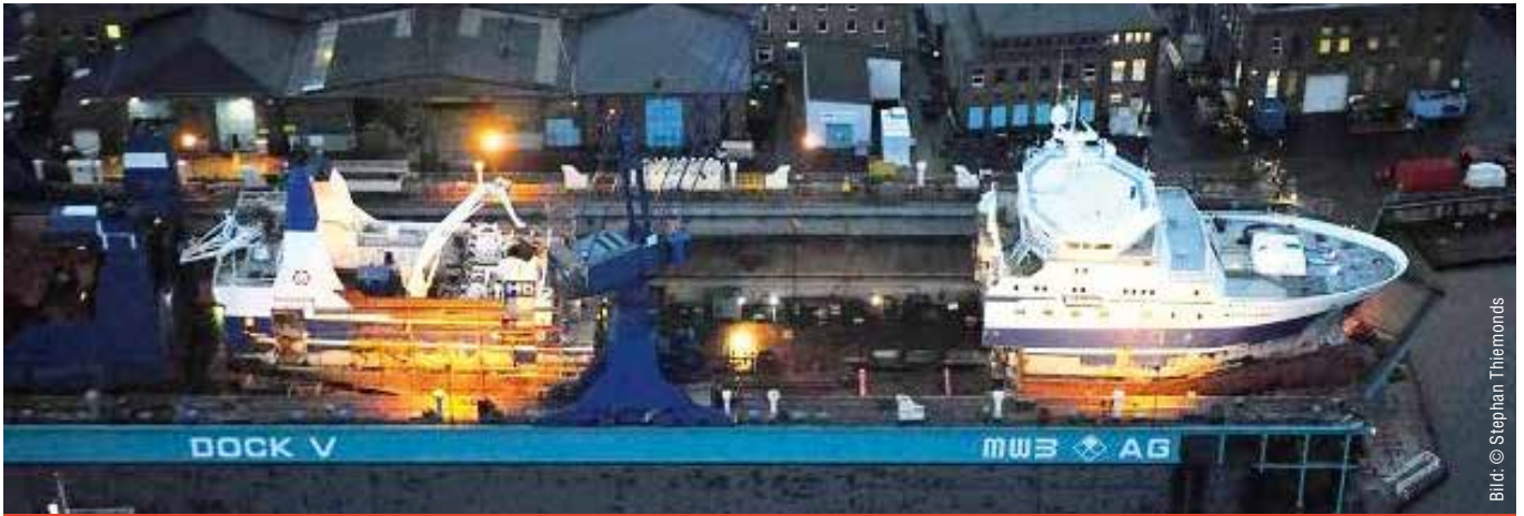
Die getrennte, auseinandergeschobene Paerangi im Trockendock.
